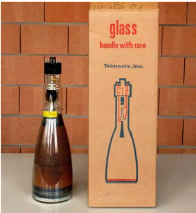
Tube cathodique à 2 faisceaux
