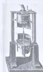
Cette double sirène est la réunion sur le même axe de deux sirènes polyphoniques de Dove (1851), qui sont elles-mêmes un développement de la sirène simple de Cagniard de la Tour, inventée en 1819. Actionnées par de l'air comprimé, les sirènes du haut et du bas émettent des sons de fréquences différentes mais de rapport bien défini. En outre, le déphasage des deux ondes sonores est ajustable.
