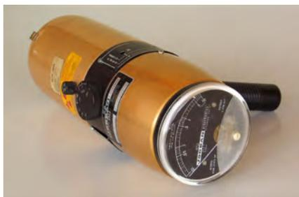
Pistolet-dosimètre ("Survey Meter Radgun")
