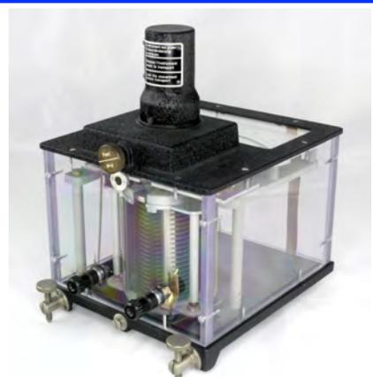
Voltmètre électrostatique multicellulaire (250 V)
