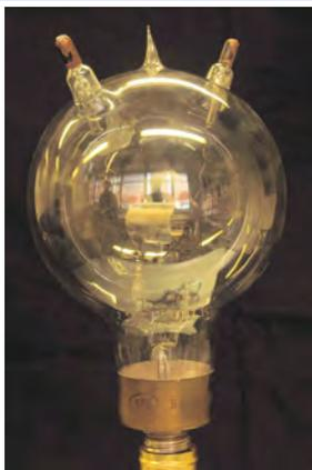
Triode d'émission à chauffage direct (SIF)
