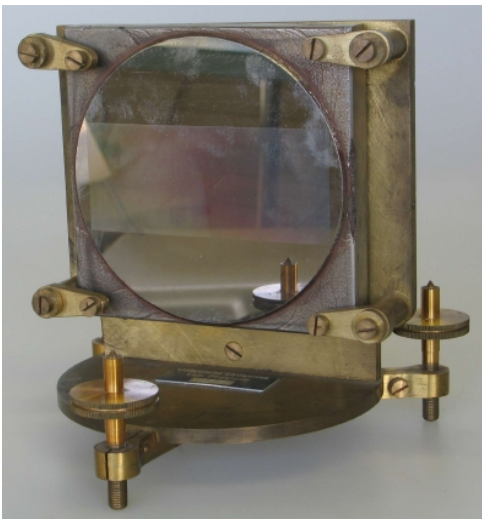
Réseau de diffraction métallique Rowland (Baltimore), 1888 14'438 lignes/pouce (Ø 100 mm)
