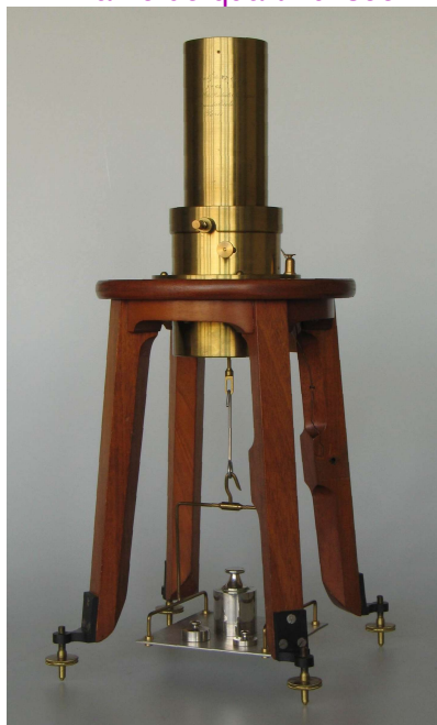
Piezo Quartz P. Curie S.C.P.C. (Paris), début XX e s. (h = 600 mm) Lame de quartz brisée
