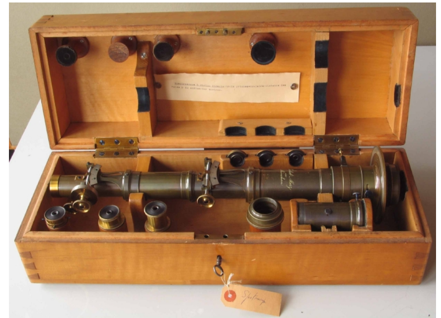
Spectroscope à vision directe, à usage astronomique 3 trains de 3 prismes Jakob Merz (München) (l = 480 mm)
