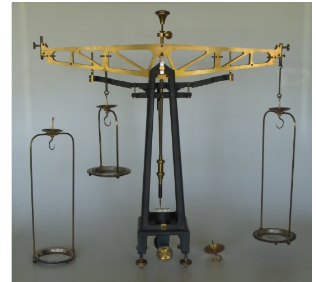
Balance de démonstration Alb. Rueprecht (Wien), après 1882 (h = 740 mm)
