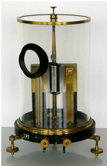
Galvanomètre à cadre mobile J. Carpentier (Paris), après 1889 (h = 310 mm)
