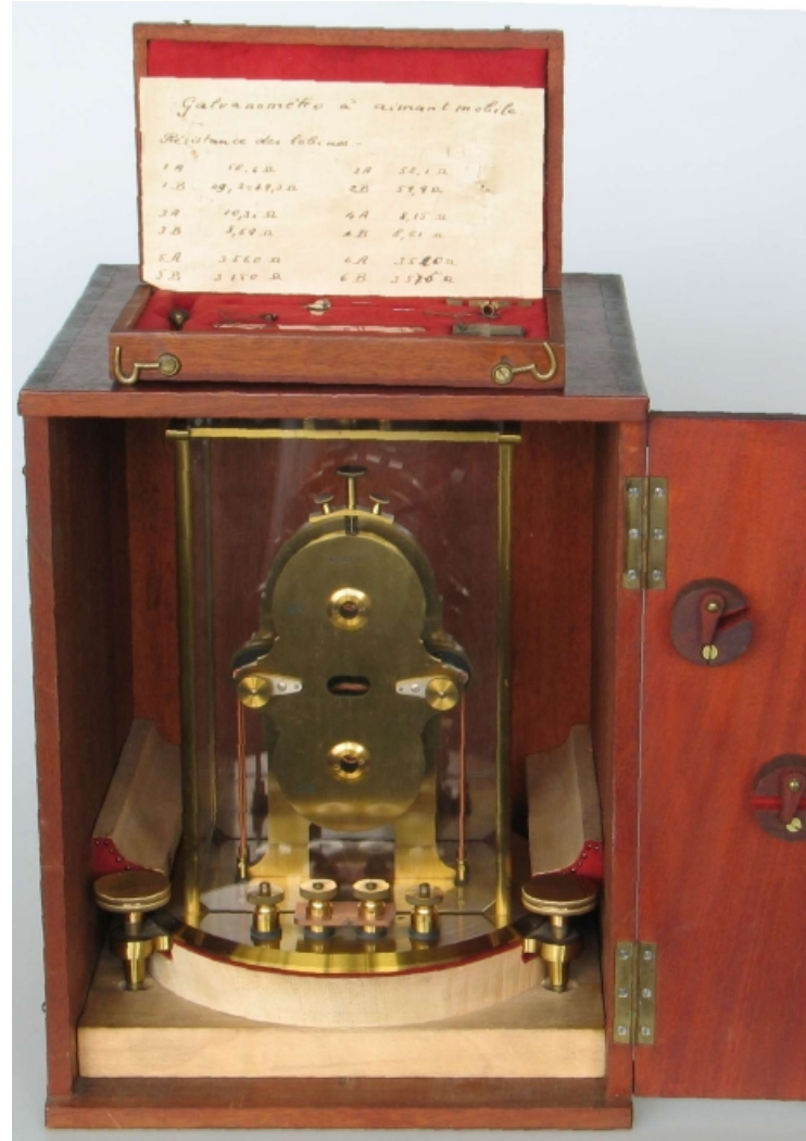
Galvanomètre astatique (W. Thomson) et accessoires At. Ruhmkorff – J. Carpentier (Paris) (hauteur du coffret 230 mm) Posée sur le coffret, boîte avec aiguilles aimantées et fil de suspension Aimants de correction perdus
