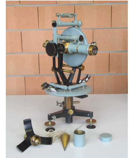
Théodolite Début XX e s. (cercle gradué horiz. Ø 180 mm)
