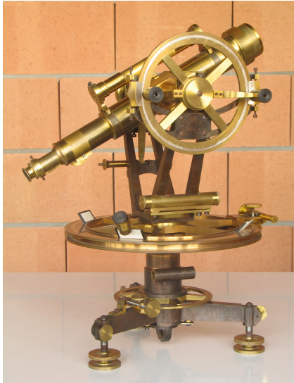
Théodolite Fin XIX e s. (cercle gradué horiz. Ø 250 mm)
