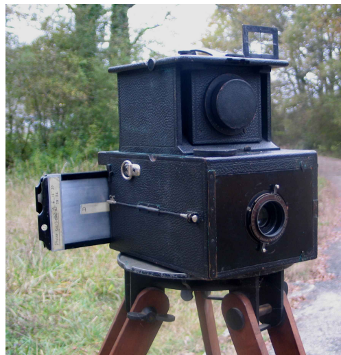
Appareil photographique réflecto-réfracteur à longue focale Brevet suisse — début XX e s. (pour plaques 100 x 150 mm 2 )
