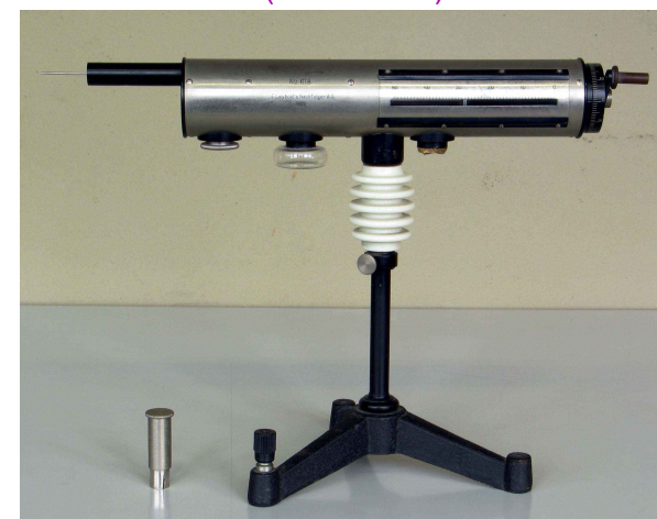
Condensateur coaxial de Wulf Leybold (Köln), après 1925 (l = 390 mm)
