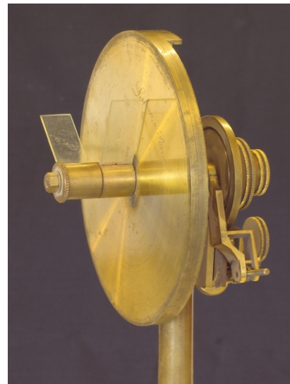
Compensateur de Jamin Lerebours (Paris), 1850-1870 ( \varnothing 135 mm)
