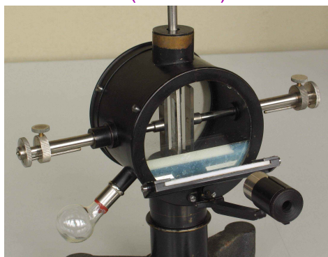
Électroscope d'après Elster et Geitel Spindler & Hoyer (Göttingen) (Ø 83 mm)
