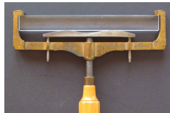
Presse pour la biréfringence Soleil Fils (Paris) (longueur 158 mm)
