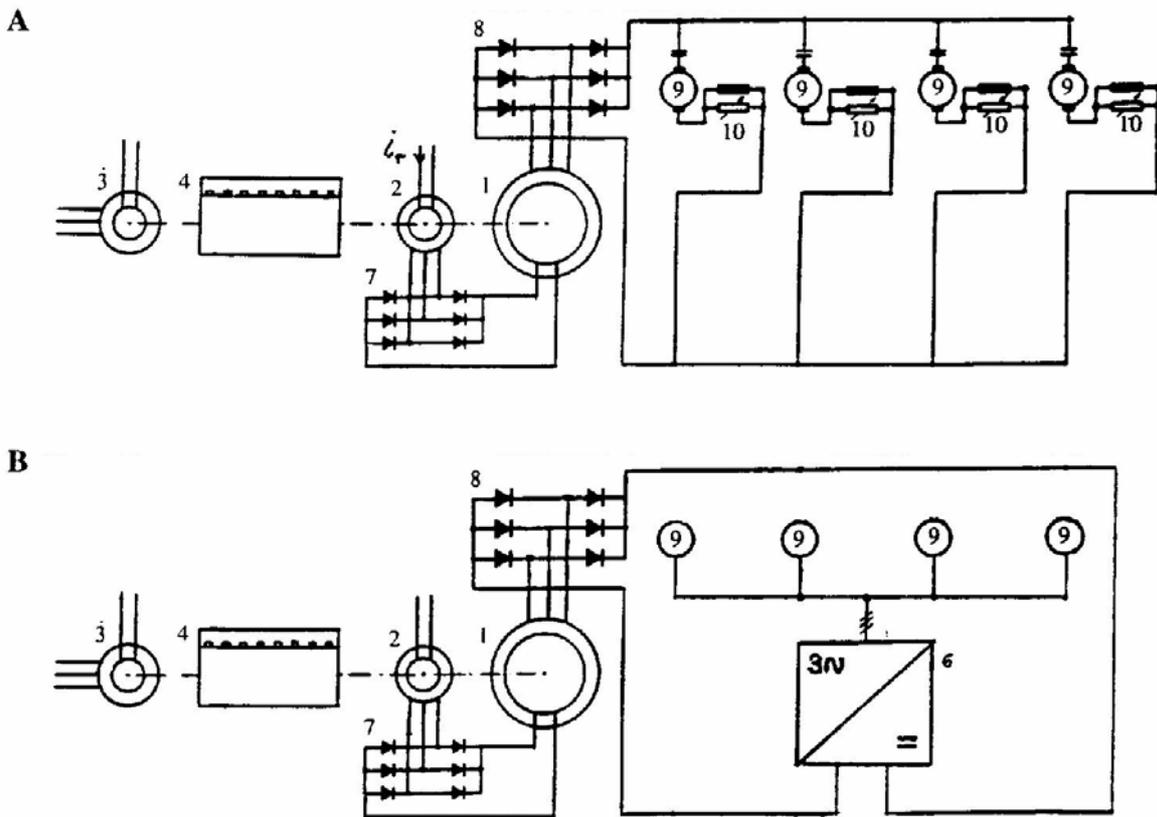
Fig. 4.218 Entraînement thermoélectrique: alternateur synchrone redressé
