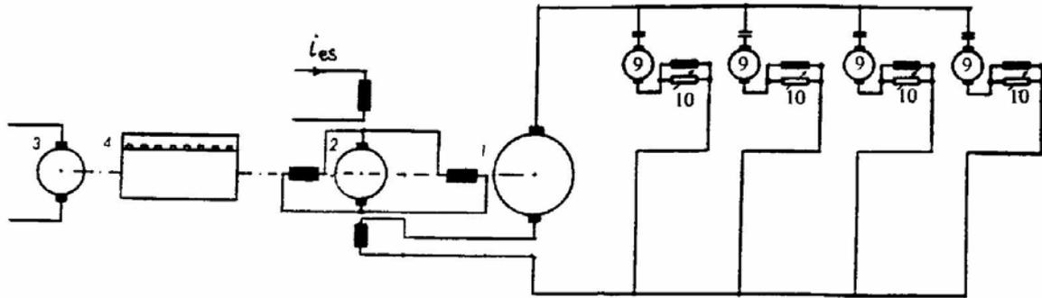
Fig. 4.207 Entraînement thermoélectrique: génératrice à courant continu.
