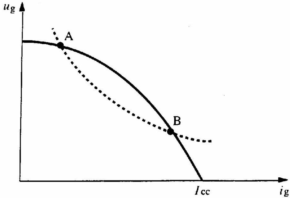
Fig. 4. 221 Caractéristique de sortie limite d'un alternateur.
