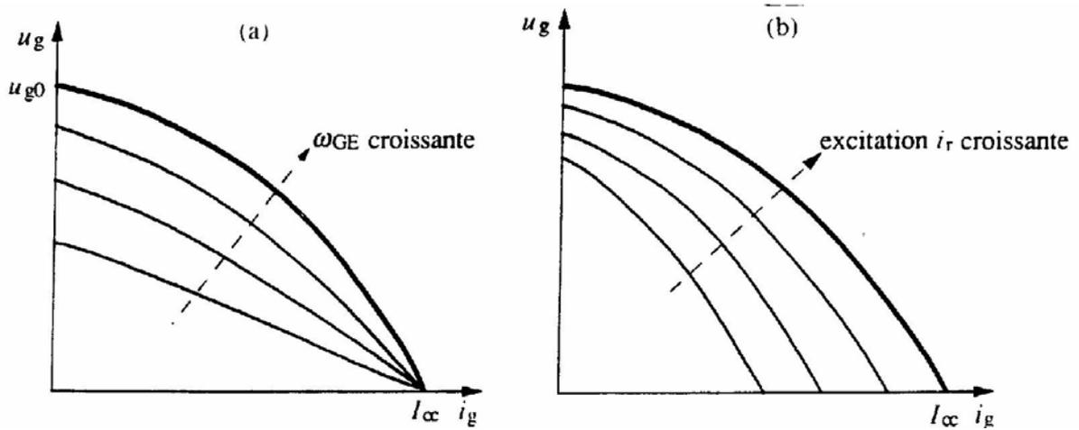
Fig. 4.222 Caractéristiques de sortie d'un alternateur :
