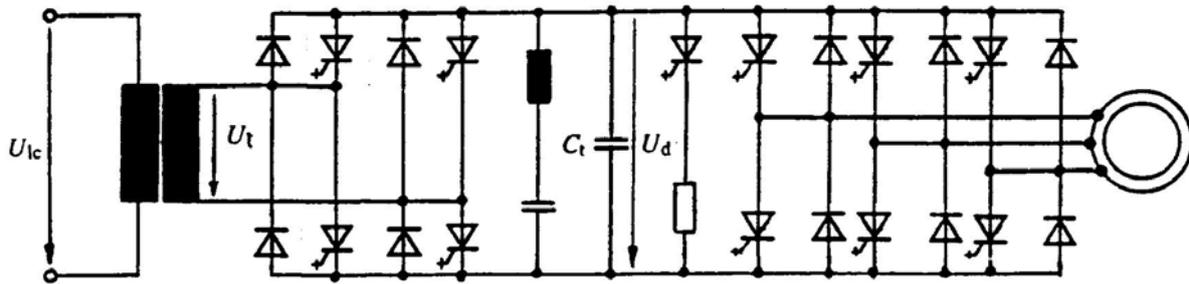
Fig. 4.166A Bidirectionnal U-converter for AC contact line (BLS : Re 465).
