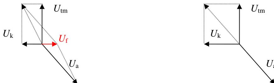
Fig. 4.40 Kommutation in einem Einphasen-Reihenschlussmotor für kleine und Nenngeschwindigkeit.
