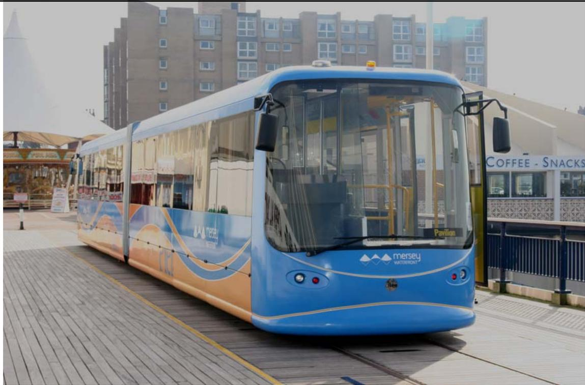
**Tramway à batteries** mise en service : 2005
