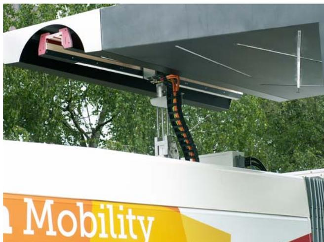
La perche est en position dans le rail de biberonnage. Sur la photo de la page 1, la perche est déjà partiellement levée à l'approche de l'arrêt. Elle se rabat dès que la charge est achevée. On distingue les arrêts en ligne, équipés de supercapacités, qui permettent au bus de soutirer 800 à 1000 A pendant 15 secondes, et les terminus, qui permettent de soutirer 400 A pendant 2 minutes, sans stockage à la station (voir schéma). Principe de charges-décharges :
