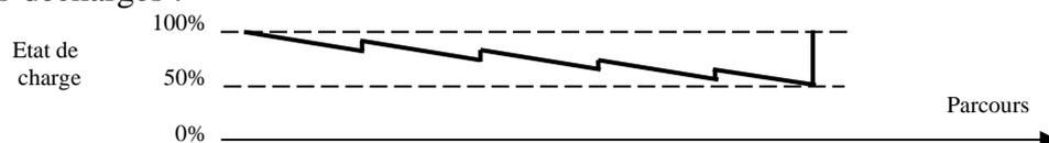
La gestion de la charge des batteries est assurée par l'électronique du bus. Les batteries lithium-ions, avec électrodes rugueuses en oxyde de titane plutôt qu'en graphite, permettent des courants de charge aussi élevés que les courants de décharge et survivent à un grand nombre de cycles qui permet une utilisation intensive sur 10 ans. Une demi-décharge permettrait une autonomie d'environ 10 km.
