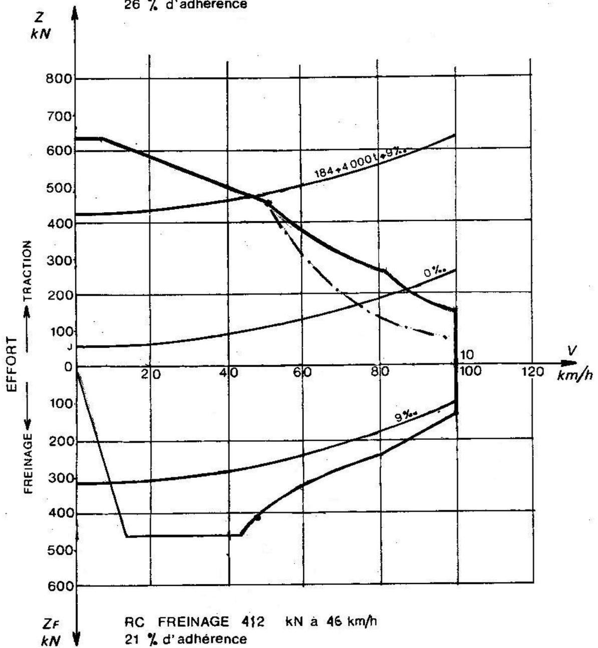
RC FREINAGE 412 kN à 46 km/h
