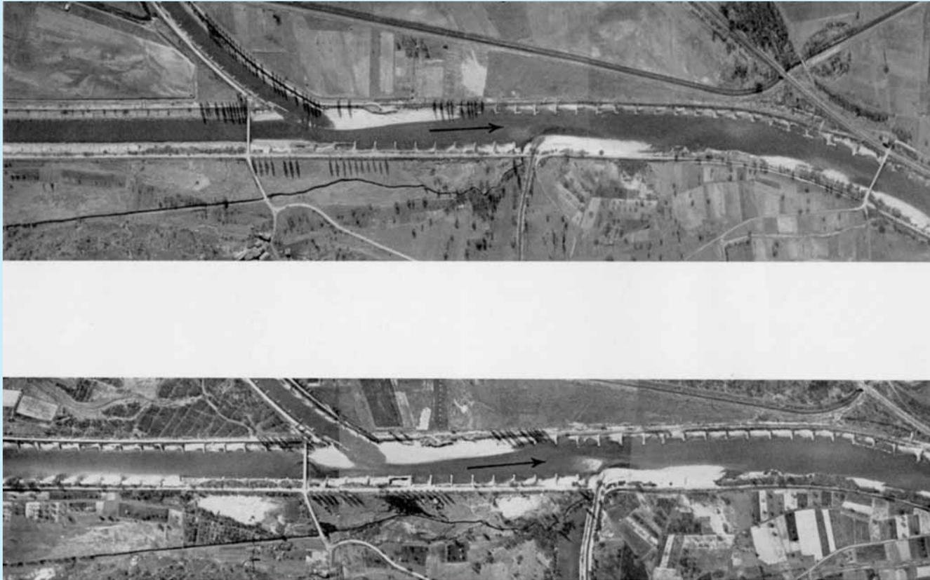
Le Rhône à l'embouchure de la Viège en 1930 (en bas) et 1938 (en haut) après l'achèvement de la correction de la Viège
