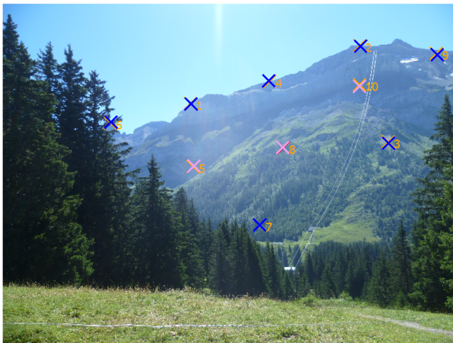
FIGURE 4.10: Tous les GCPs sont oranges. Ceux qui participent à la pose ont leur reprojection en bleu ; ceux qui ne participent pas ont leur reprojection en rose. En résumé, les points ne participants pas à l'estimation de la pose en une précision similaire que les autres. Les précédents résultats peuvent donc être également lus ainsi, avec la retenue nécessaire.
