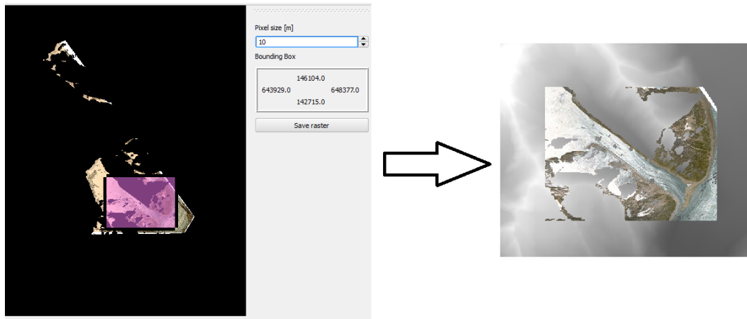
FIGURE 1.4: Exemple d'ortho-rectification. Il est possible d'y définir les coordonnées limites et la résolution du fichier raster.
