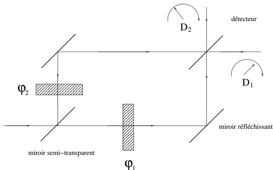
Une source de photons unique envoie un photon dans l'interféromètre. Le photon passe à travers un miroir semi-transparent, puis est déphasé par les déphaseurs  $e^{i\varphi_1}$  et  $e^{i\varphi_2}$ , puis est réfléchi par les miroirs réfléchissants et enfin passe à travers le dernier miroir semi-transparent. Le processus de mesure correspond à une détection dans les photo-détecteurs  $D_1$  et  $D_2$ .
