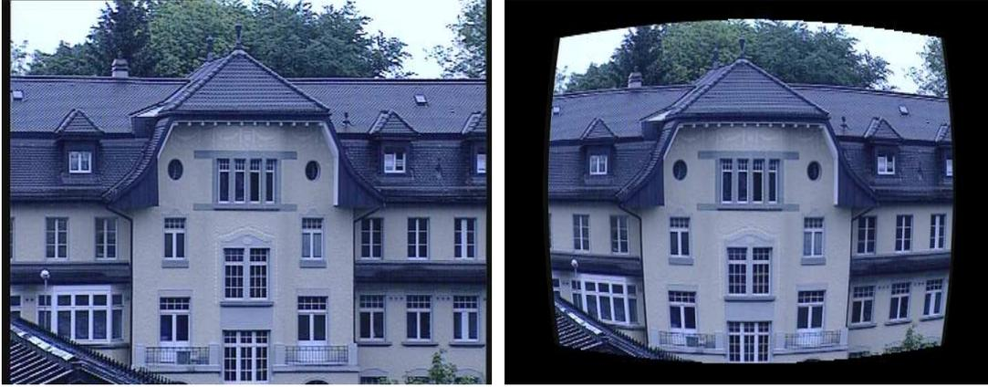
FIG. 1.13 – La déformation d’image peut être considérée comme un système qui transforme les signaux à deux dimensions. Sur la gauche, l’image originale ( $288 \times 720$  pixels). Sur la droite, l’image de sortie obtenue en posant  $\rho = 2e - 6$ .
