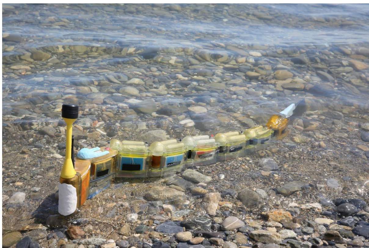
Le robot est capable d'effectuer des mesures et d'envoyer les résultats à un ordinateur en temps réel © EPFL / Alain Herzog
