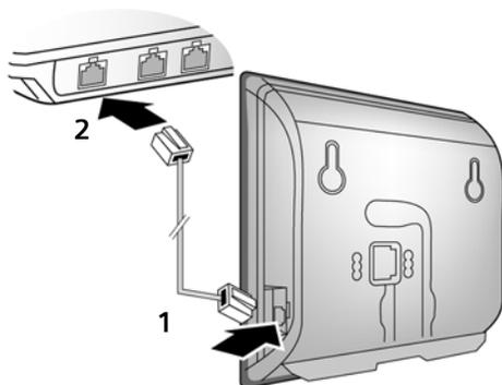
1. Brancher une extrémité du câble Ethernet à la prise LAN sur le côté de la base.
