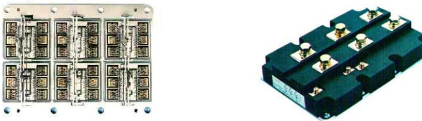
**Fig. 16** – Vues intérieure et extérieure du transistor IGBT
